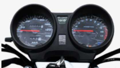
NUEVO TABLERO CON INDICADOR DE MARCHA
